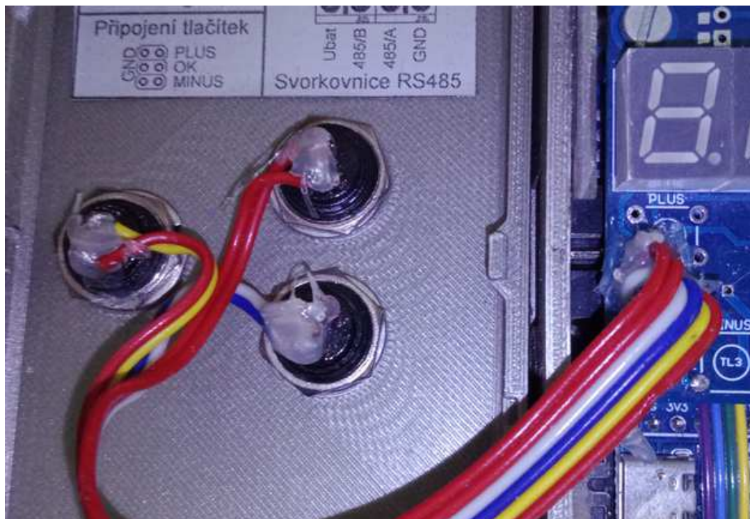
Propojení 6-žilovým plochým kablíkem. Každé tlačítko má 2 samostatné dráty, spojení GND je až na desce DIS. (fotografie starší verze krabičky)
