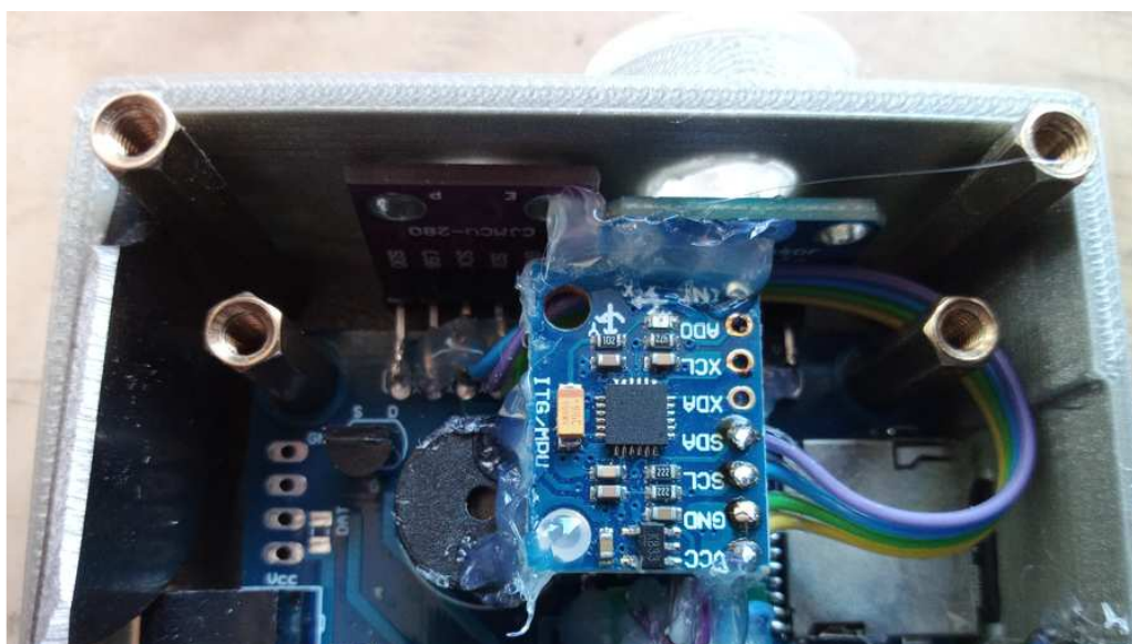
Ukázka skutečného uložení náklonoměru pro verzi 1
