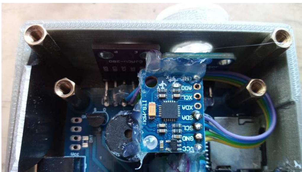
Ukázka skutečného uložení náklonoměru pro verzi 1
