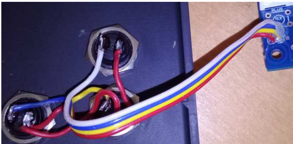
Připojení 4-žilovým plochým kablíkem. (Společné GND je propojené na tlačítkách - červený drát.)
