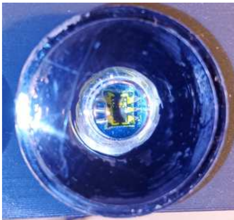
snímací čip přímo proti čočce
