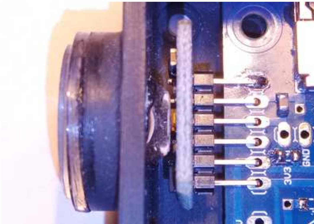
poloha modul čidla světla se seřídí připájením v jednom bodě
