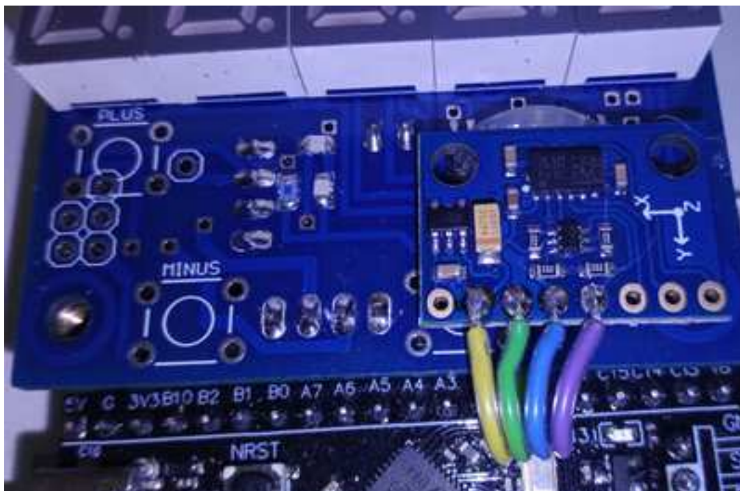
modul kompasu nalepený na displejové desce (na obvodu TM1637)
